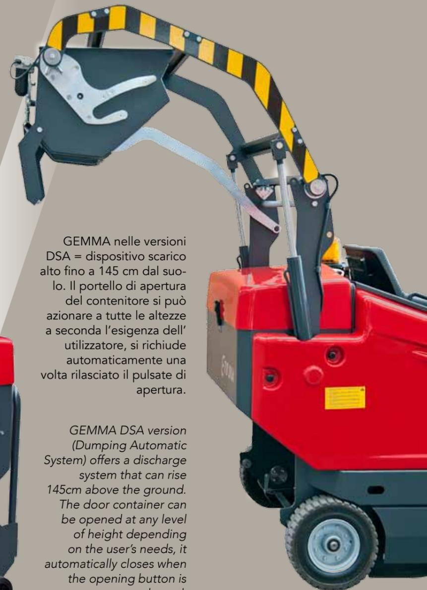
GEMMA nelle versioni DSA = dispositivo scarico alto fino a 145 cm dal suolo. Il portello di apertura del contenitore si può azionare a tutte le altezze a seconda l'esigenza dell'utente, si richiude automaticamente una volta rilasciato il pulsante di apertura.
