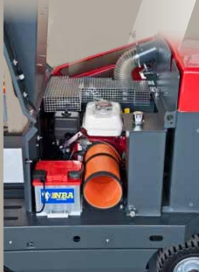
GEMMA S78 nella versione a con motore a benzina HONDA 6,5 HP con start elettrico e frizione centrifuga per avviamento.
